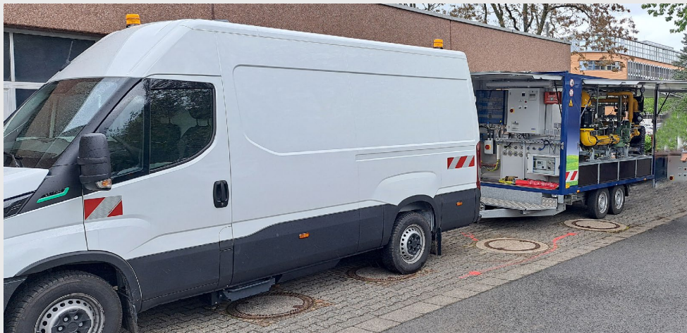
Abb. 01: Die feste Installation auf einem Pkw-Anhänger ermöglicht den Transport der mobilen Gasdruckregelanlage. [Foto: Ohra Energie GmbH]
