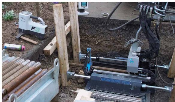
Abbildung 26: Mini-Spülbohrsystem, eingesetzt in einer Startgrube im Gehweg; Gestängemagazin.
