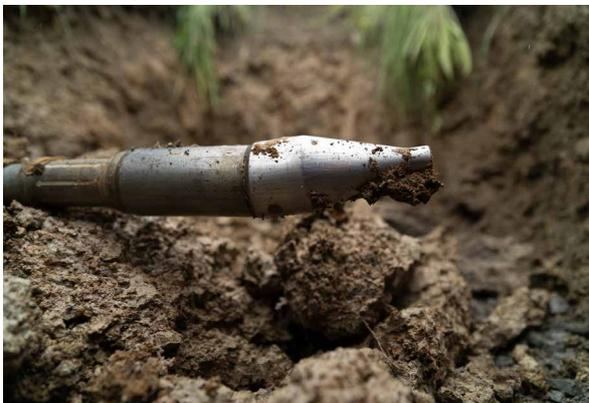
Abbildung 34: Steuerkopf des Richtpressverfahrens.
