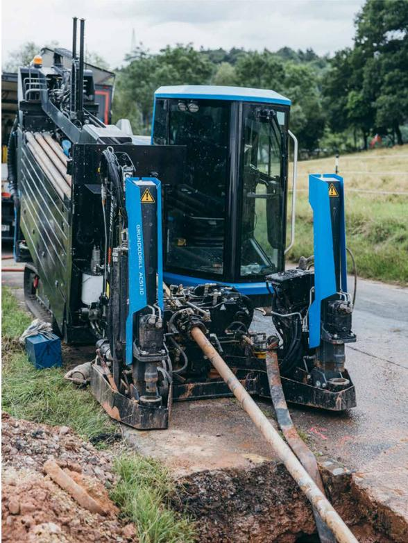
Abbildung 24: Maschine für das Horizontal-Spülbohrverfahren.
