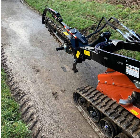
Abbildung 4: Fahrzeug mit montierter Kettenfräse (stillstehend).
