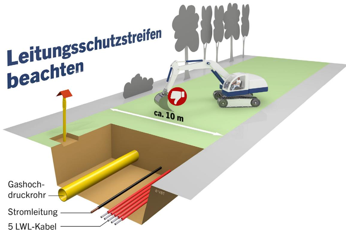
Abbildung 9: Beispiel für den Schutzstreifen einer Transportleitung
