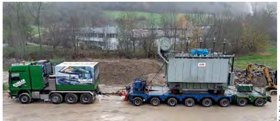
Transport des tonnenschweren Transformators mit dem Tieflader.
