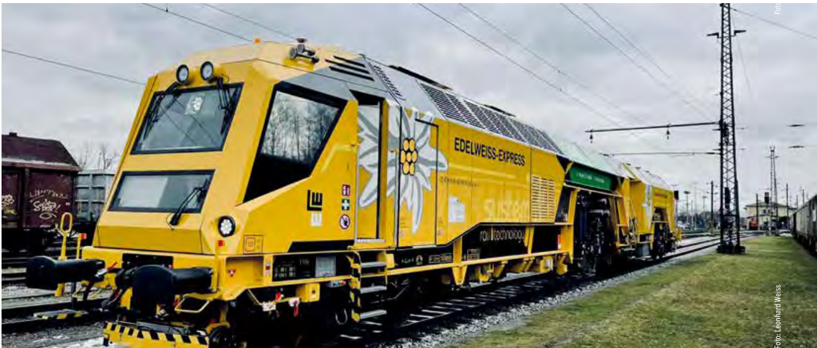
Der neue Gleisstropfroboter S7 PLS 16 4.0 – S mit dem Namen EDELWEISS-EXPRESS.
