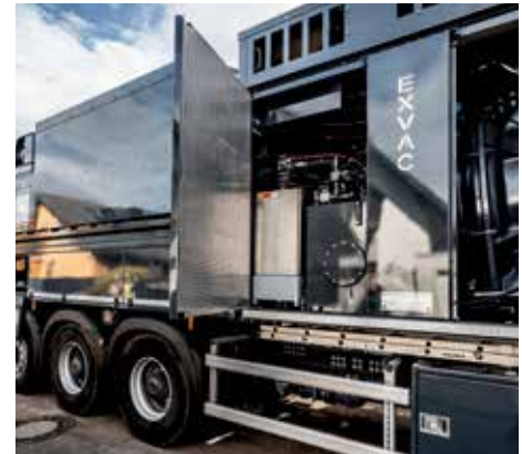
Komplexe Maschine: Sechs Hochleistungsfilter halten die Abluft staubfrei
