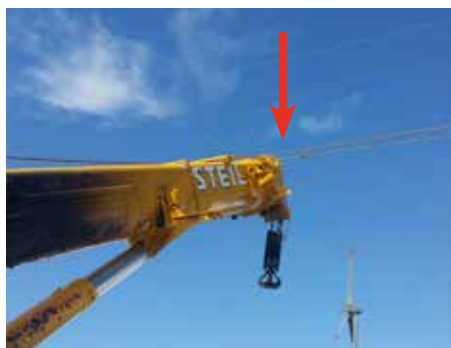
Hier ist ein Kranausleger in die Hochspannung geraten und das Fahrzeug ist abgebrannt
