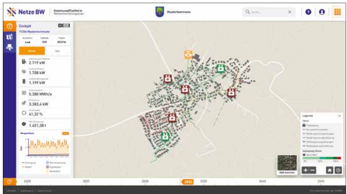
Mehr Durchblick bei der Energieinfrastruktur: Die KommunalPlattform der Netze BW macht's möglich. Eines der fünf Module: die Netzentwicklung. Hier erhalten Konzessionskommunen einen Überblick über die erwartete Netzauslastung in den kommenden Jahren.
