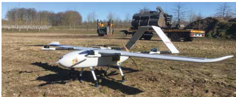
Die selbst entwickelte Drohne Beagle M ist auf Langstreckenflüge ausgelegt
