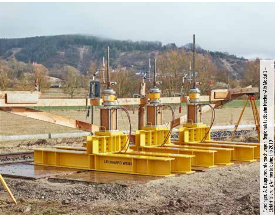
Bild 3: Ammertalbahn, simultane Probelastung an drei Duktirampfpfählen, IGS Institut für Geotechnik der Universität Stuttgart
