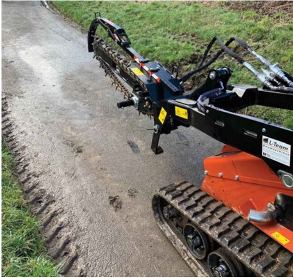
Abbildung 9: Fahrzeug mit montierter Kettenfräse Quelle: Deutsche Telekom Technik GmbH
