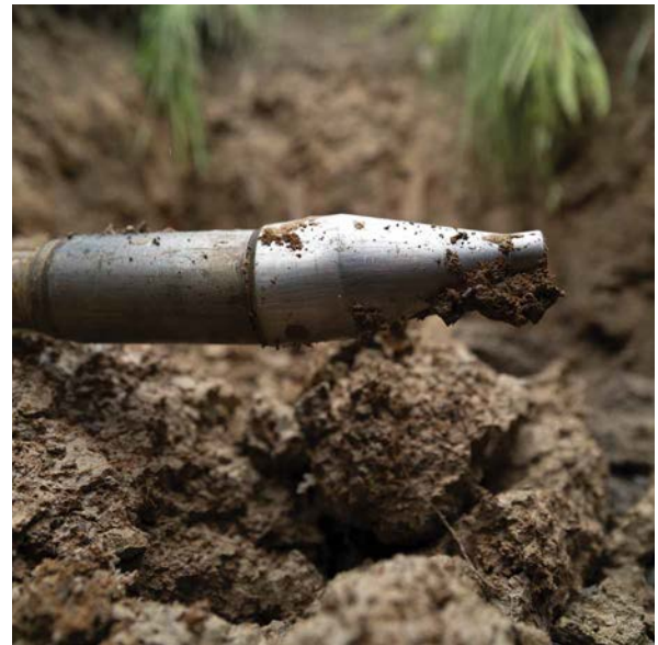
Abbildung 42: Steuerkopf des Richtpressverfahrens Quelle: TRACTO-TECHNIK GmbH & Co. KG
