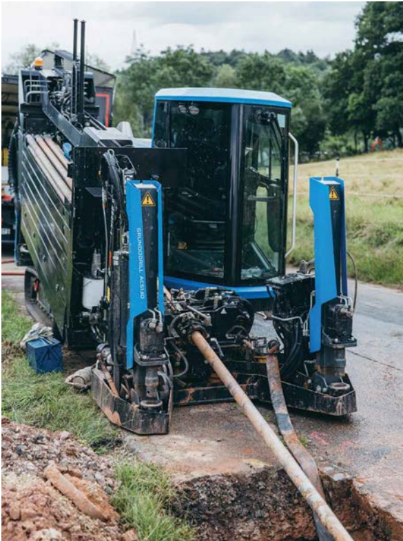
Abbildung 29: Maschine für das Horizontal-Spülbohrverfahren Quelle: TRACTO-TECHNIK GmbH & Co. KG
